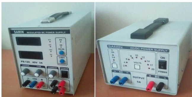
شکل ۴- منابع تغذیه DC/AC و DC
