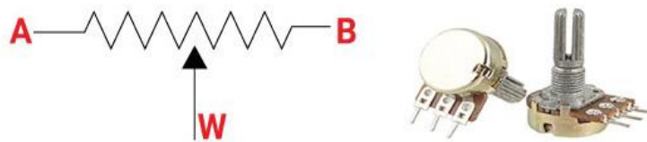
شکل ۱۱- پتانسیومتر و نماد آن در مدارات الکتریکی
